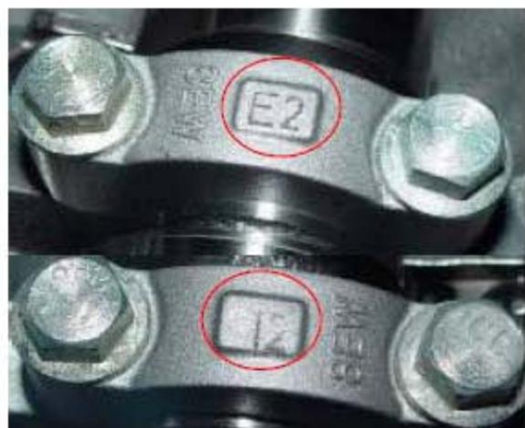
8). 进、排气凸轮轴轴承盖的拆卸顺序图。
