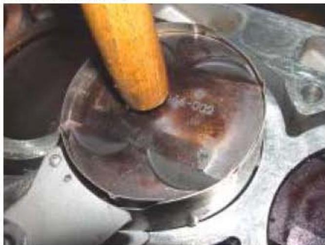
**注意：**连杆上有点的一方应朝向发动机一缸方向。而且要和活塞顶面上箭头方向一致。
