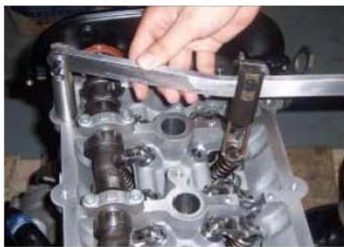
11). 用气门油封专用工具拆下旧的气门油封。
