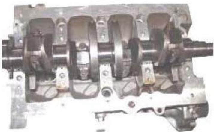
3). 扣上缸体框架，拧上曲轴紧固螺栓。
