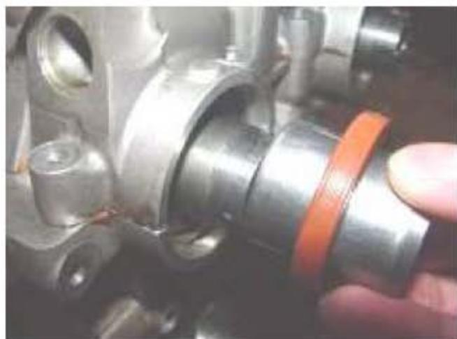
4). 将油封小心压入油封座圈，并用锤子敲到位。
