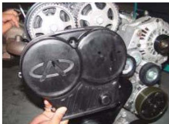
2). 拆下发动机正时皮带下罩盖。
