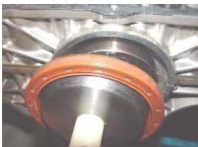
2). 在曲轴后油封唇口上均匀的抹上一层机油，在油封外圈上均匀涂上少许机油。
