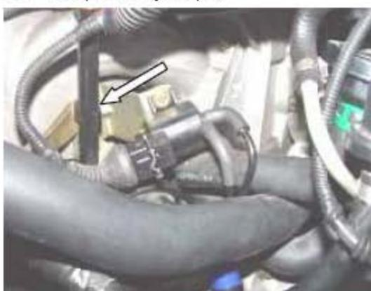
4). 拆下进气软管与节流阀体连接处的卡箍。
