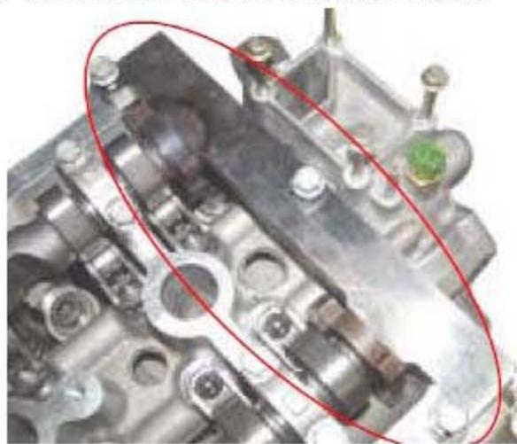
7). 用扭力扳手松开进、排气凸轮轴带轮螺栓。
