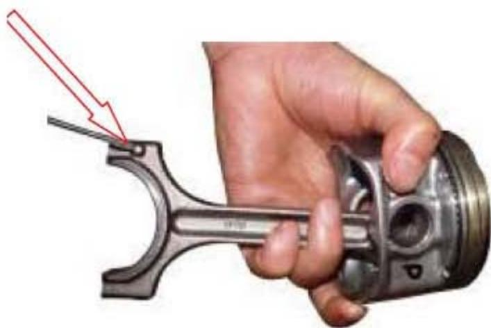
5). 将连杆下瓦和连杆盖装在一起。并在瓦上涂发动机润滑油。
