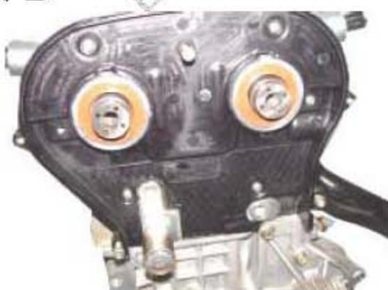
7). 依次拆下进排气凸轮轴轴承盖，并按顺序放好。
