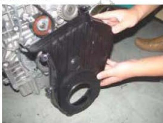
3). 松开正时皮带涨紧轮中心螺栓，取下正时皮带。
