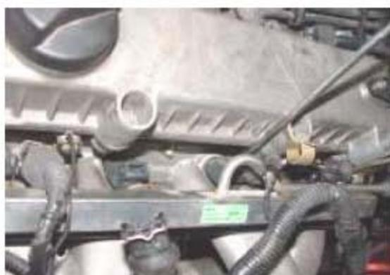
3). 拆下机油标尺管与进气歧管的连接螺栓。
