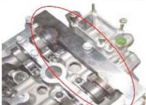
5). 用扭力扳手拆下进排气凸轮轴带轮。
