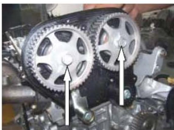
6). 拆下正时皮带后护盖。
