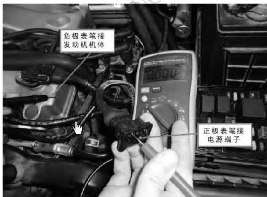
图 1 测量点火线圈插头电源端子电压
