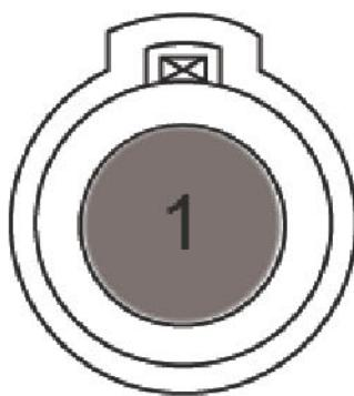
A). 启动发动机，按下空调控制开关(A/C 开关)，检测压缩机离合器供电端 EN06-1 的电压。电压标准值：11-14V
