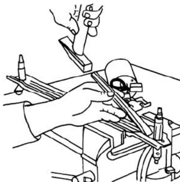
刮水器支座的拆卸
