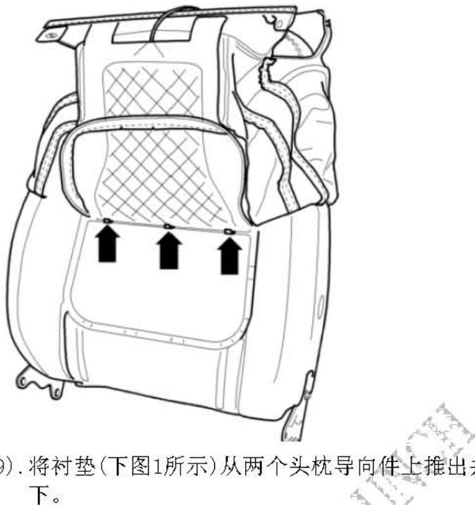
29). 将衬垫(下图1所示)从两个头枕导向件上推出并从座椅骨架(下图2所示)上拆下。
