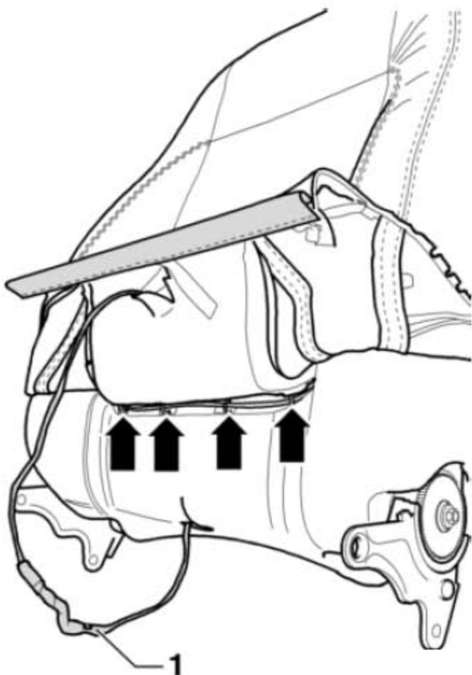
24). 使用解锁工具拆下靠背部右侧和左侧的卡扣(下图1所示)。
