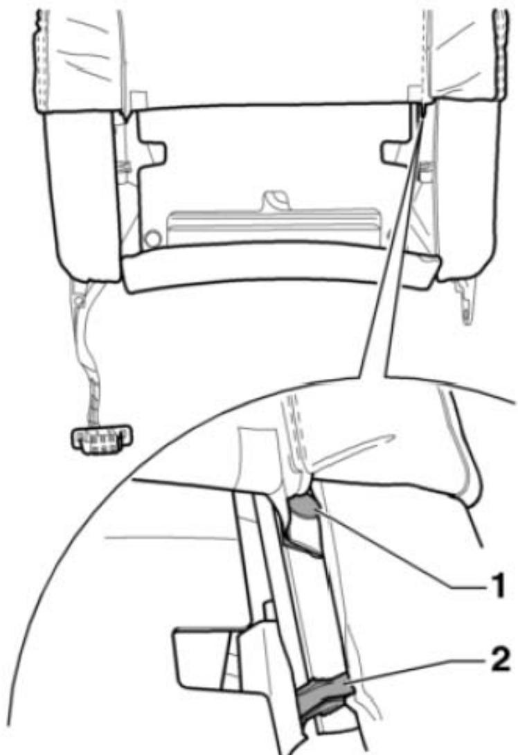
26). 向上折回座套，使用一把小的螺丝刀，从衬垫的支架上松开座套固定条(下图箭头所示)。
