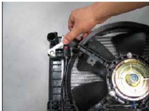
②松开线插向上拉出风扇总成
