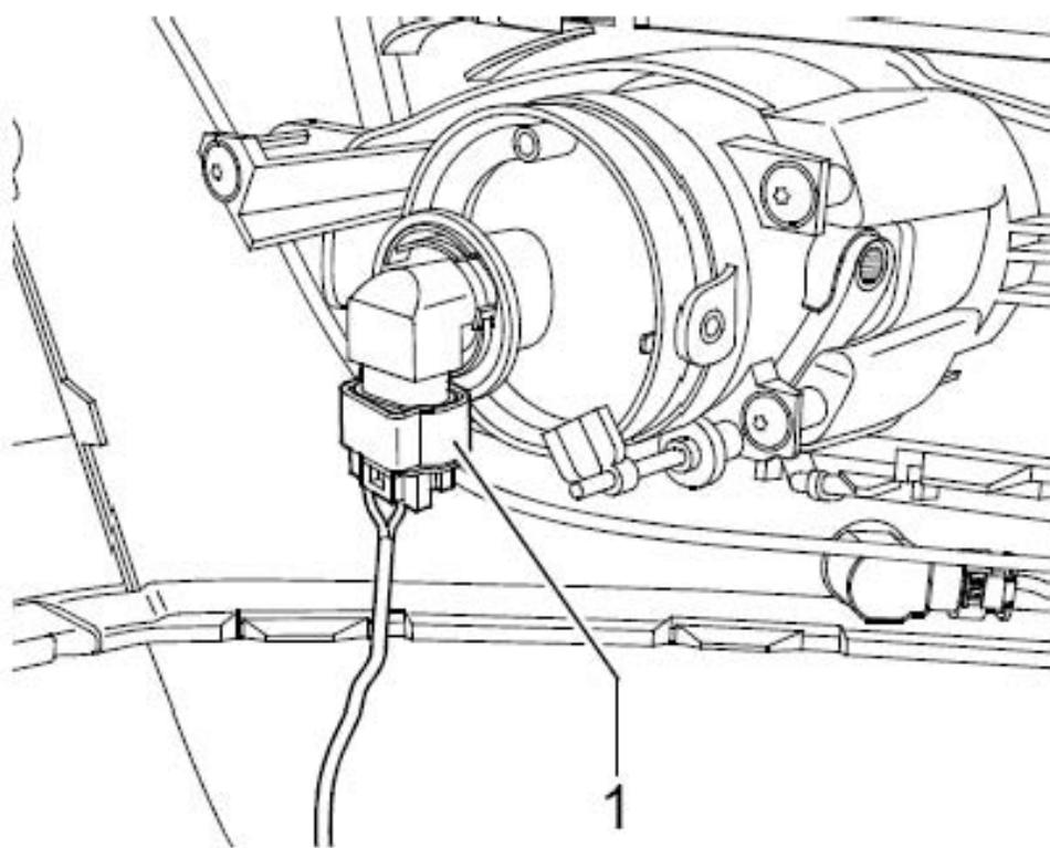
4). 沿(下图箭头所示)方向转动连同雾灯灯泡的灯座(下图1所示)并从雾灯上拆下。
