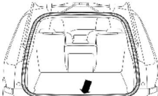
29). 请另一位技术人员在车内协助, 检查并记录尾门弹簧锁锁闩板相对于尾门锁闩, 任何校正不当的位置。
