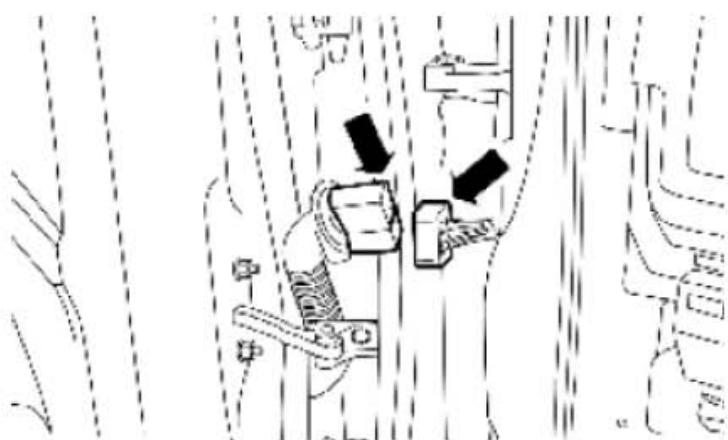
40). 将电气接头连接至A-柱。
