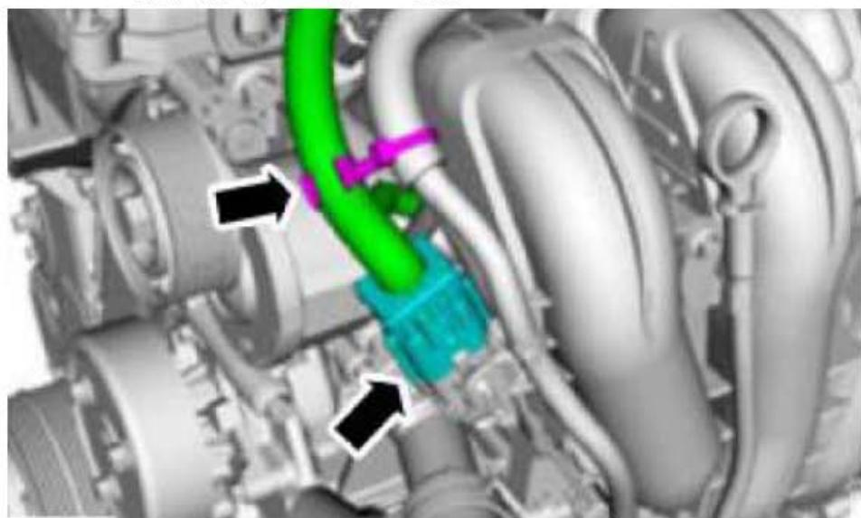
3). 从发动机上拆开发动机线束固定夹。
