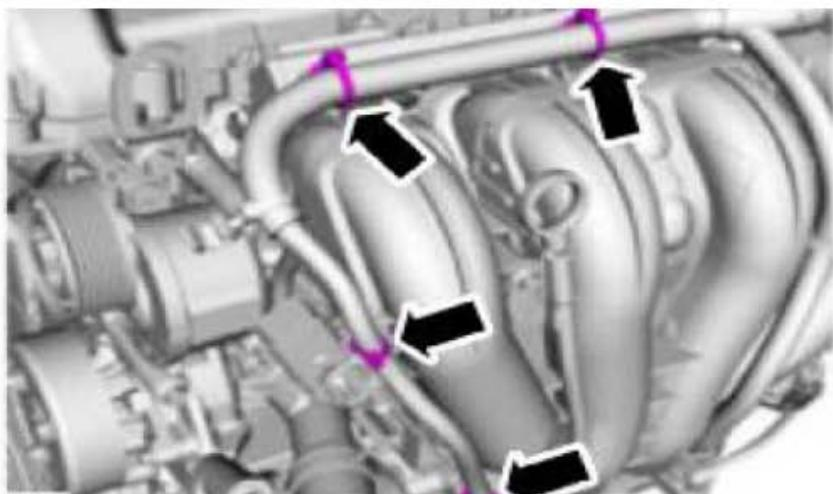
4). 从固定夹上拆开发动机线束电气接头并且将发动机线束移到一边。
