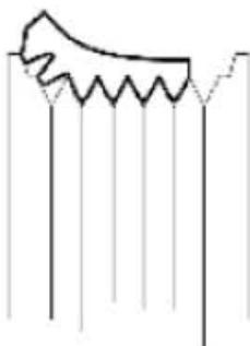
2) . 确认是否皮带上的所有 V 形沟槽都与皮带盘正确接触。
