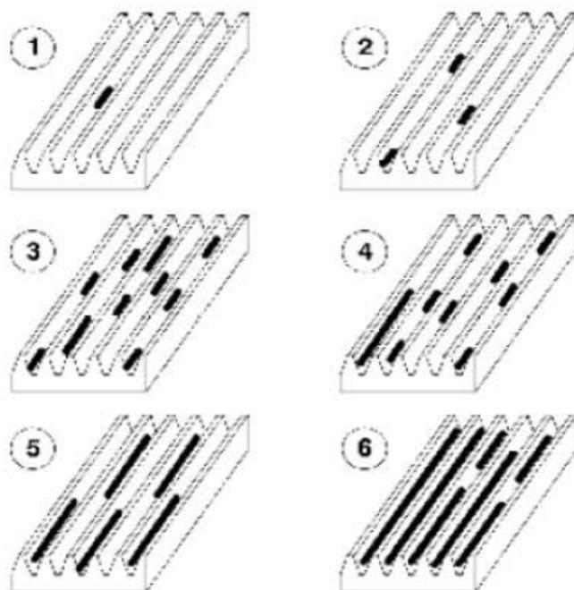
检查附件驱动皮带结块。皮带的状况必须与图示做比较。
