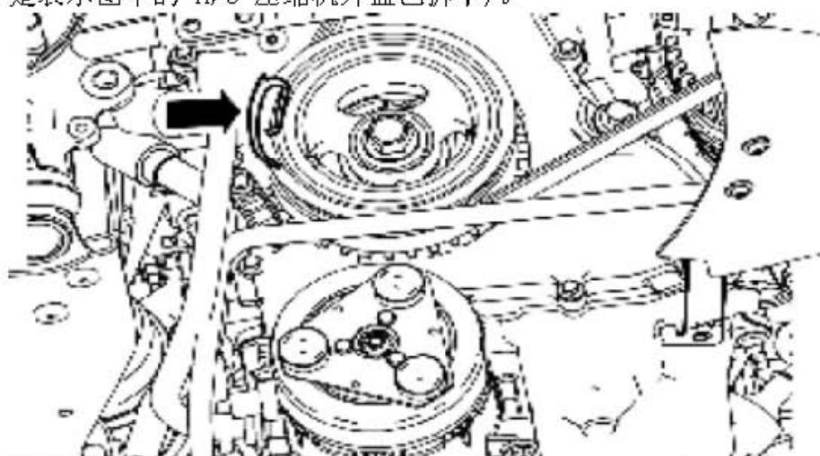
3). 安装 A/C 压缩机皮带 (为清楚表示图中的 A/C 压缩机外盖已拆下)。
