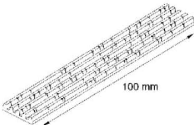
检查附件驱动皮带是否破裂。如果损坏超出可接受的范围时，则安装新的附件驱动皮带。
