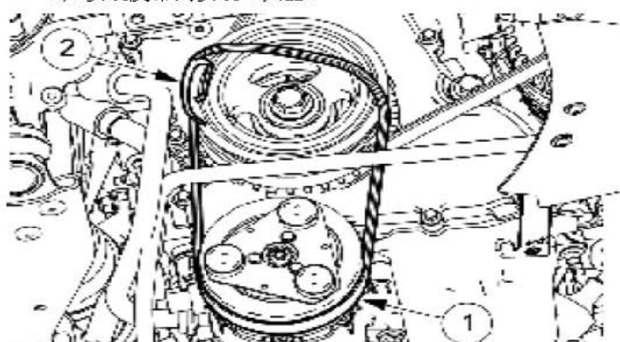
4). 安装皮带导引工具 (零件包中所提供) 到 A/C 压缩机皮带上 (为清楚表示图中的发动机已被拆下)。
