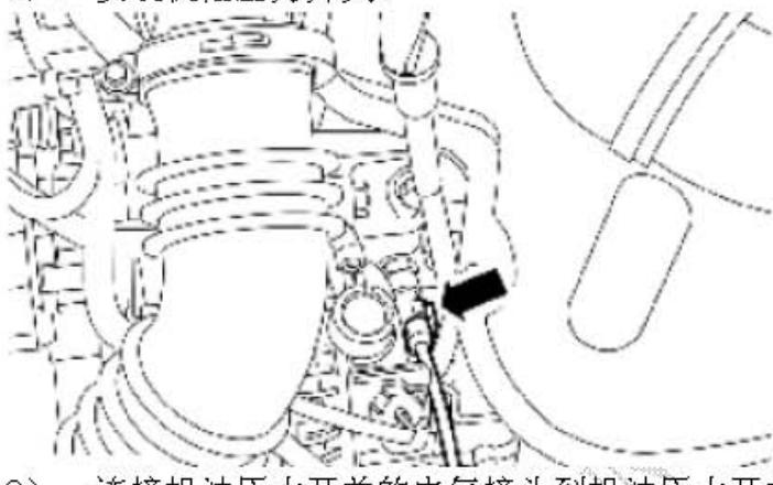
8) . 连接机油压力开关的电气接头到机油压力开关。
