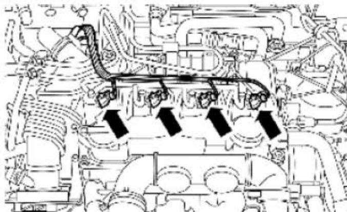
9). 拆开燃油喷油嘴电气接头。
