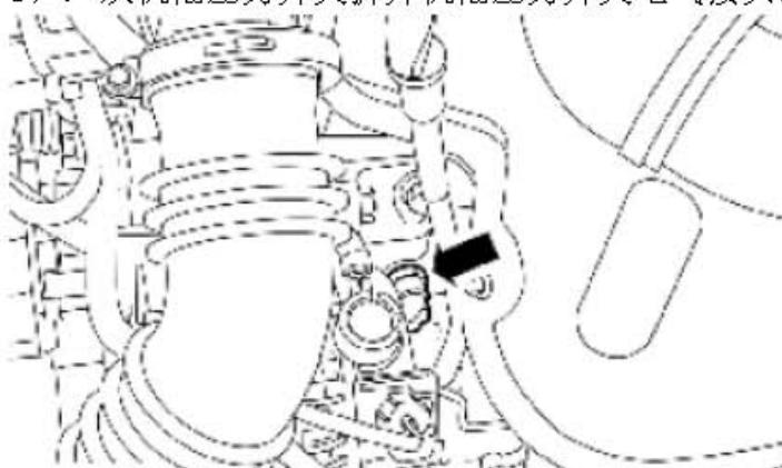
2) . 拆卸机油压力开关。
