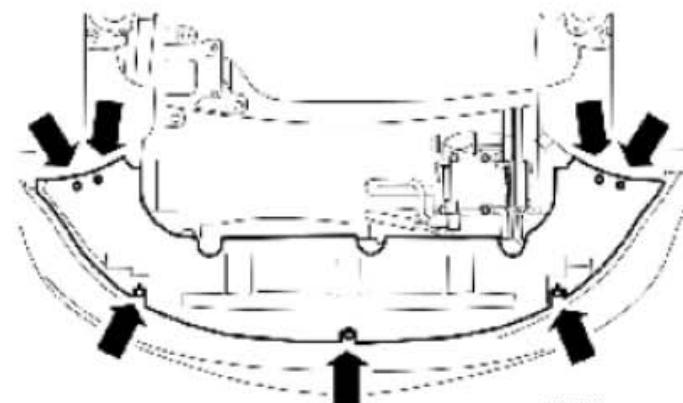
26) . 安装散热水箱下护板。
