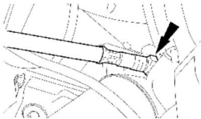
8). 从机油压力开关缸径中拆开机油压力表与接头。
