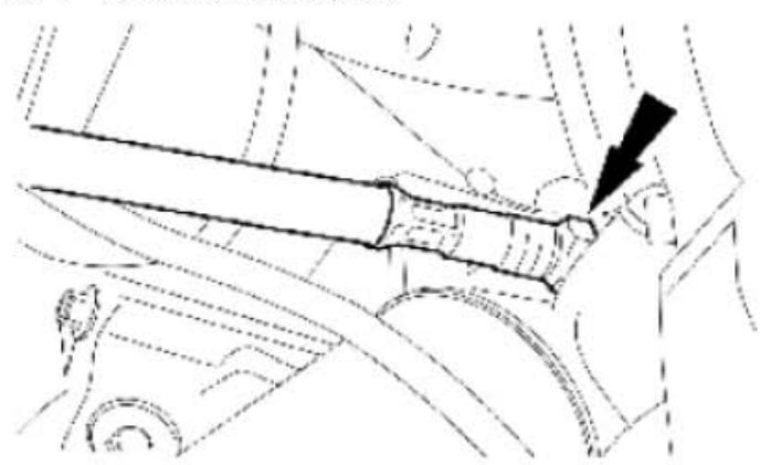
4) . 将机油压力表接头连接到机油压力开关缸径来连接机油压力表，并且让读数位置朝上放置。
