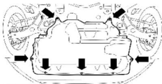
25) . 安装发动机下护板。
