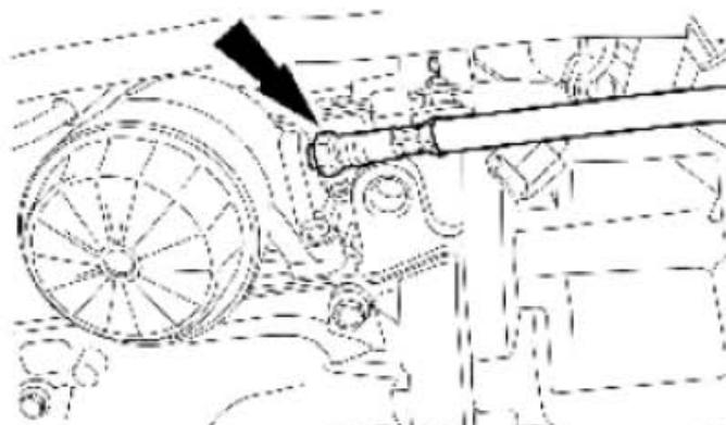
5) . 将机油压力表接头连接到机油压力开关缸径来连接机油压力表，并且让读数位置朝上放置。
