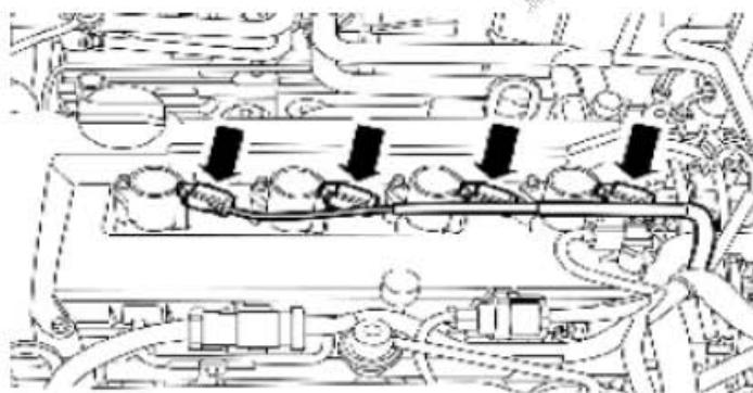
7) . 拆开点火线圈顶置火花塞的电气接头。
