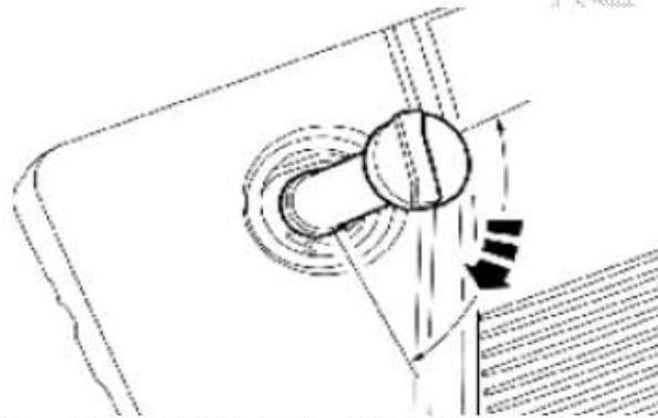
15). 安装机油添加管。顺时针转动机油添加管大约90度直到固定扣卡簧卡入定位。
