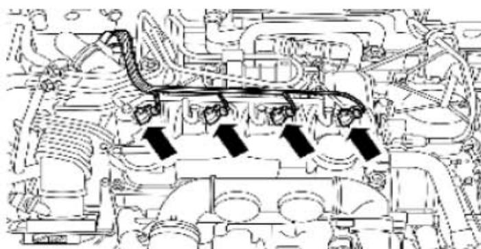
19) . 连接燃油喷油嘴电气接头。
