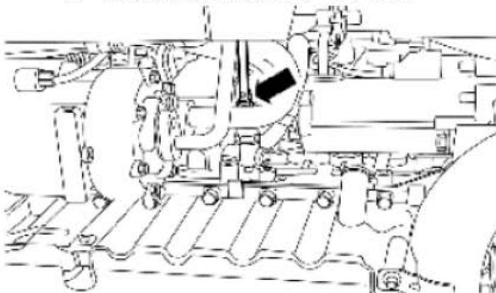
7). 拆开机油压力表与机油压力表接头。
