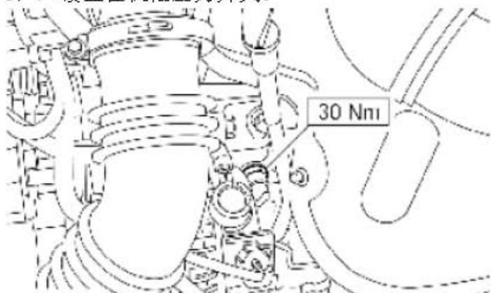
7) . 安装机油压力开关。
