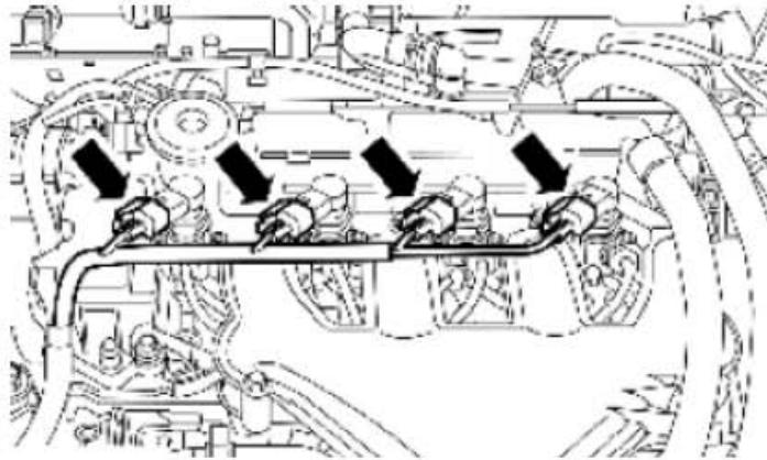
21). 连接燃油喷油嘴电气接头。
