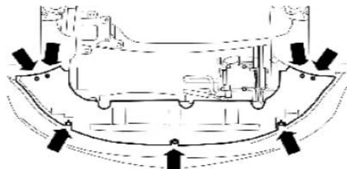
4) . 拆卸散热水箱下护板。
