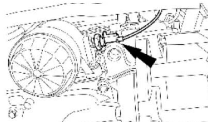
12). 连接机油压力开关电气接头到机油压力开关。
