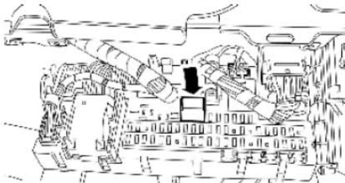
11) . 安装燃油泵继电器并关闭 CJB。
