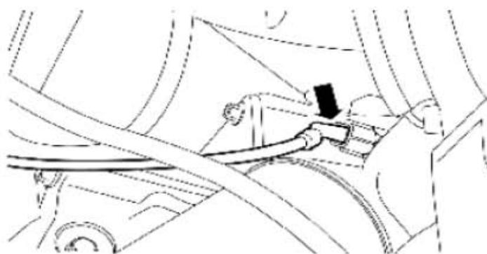
11). 连接机油压力开关的电气接头到机油压力开关。
