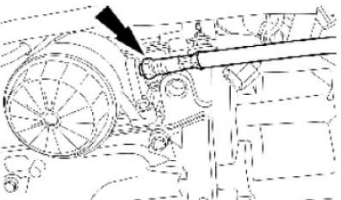
9). 从机油压力开关缸径上拆开机油压力表与接头。
