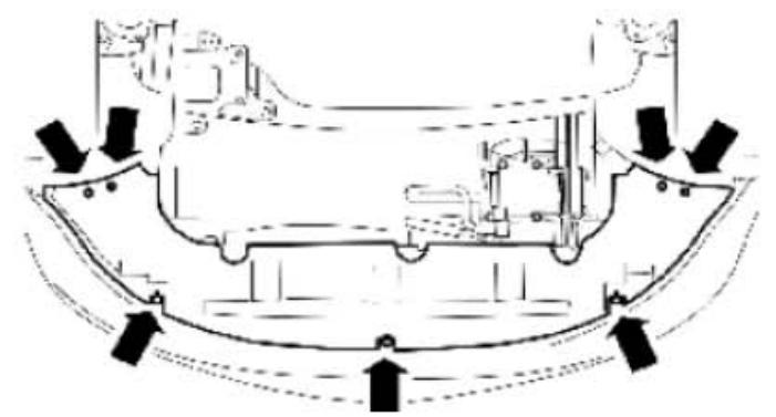
24) . 安装散热水箱下护板。
