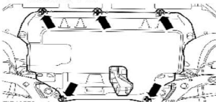
2) . 拆卸发动机下护板。
