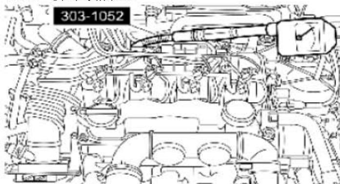
13). 安装专用工具以及适当的压缩比测试器到预热塞缸径上。
