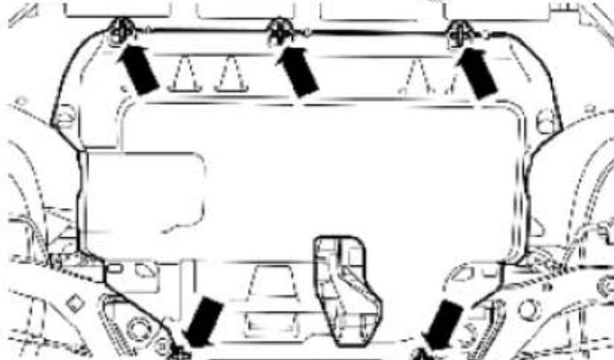
13). 安装发动机下护板。
