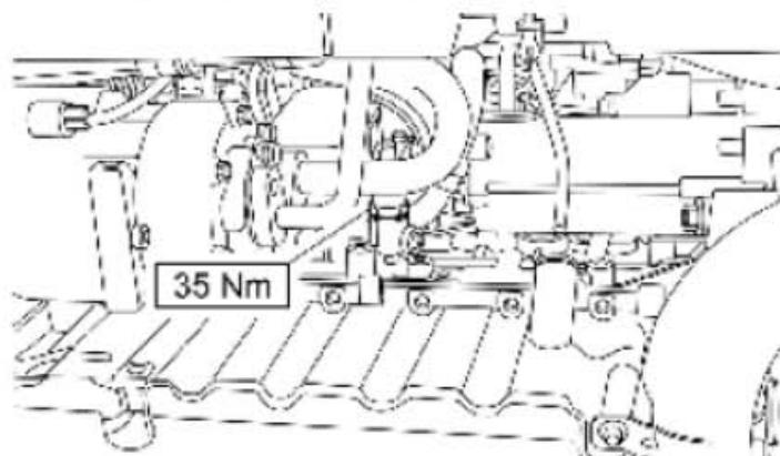
9) . 安装机油压力开关。
