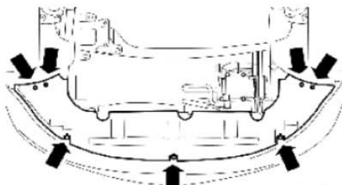
4). 拆卸散热水箱下护板。
