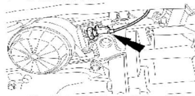
3). 从机油压力开关上拆开机油压力开关电气接头。
