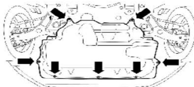
3) . 拆卸发动机下护板。
