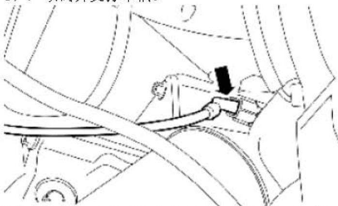
2) . 从机油压力开关上拆开机油压力开关的电气接头。
