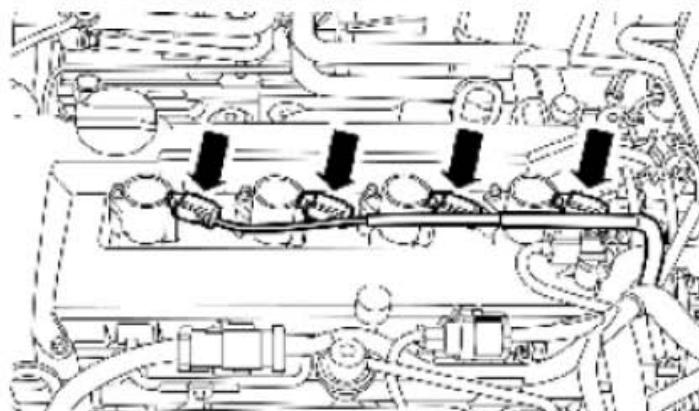
13). 连接点火线圈顶置火花塞电气接头。
