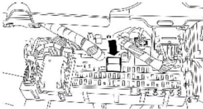
2) . 打开 CJB 并拆卸燃油泵继电器。
