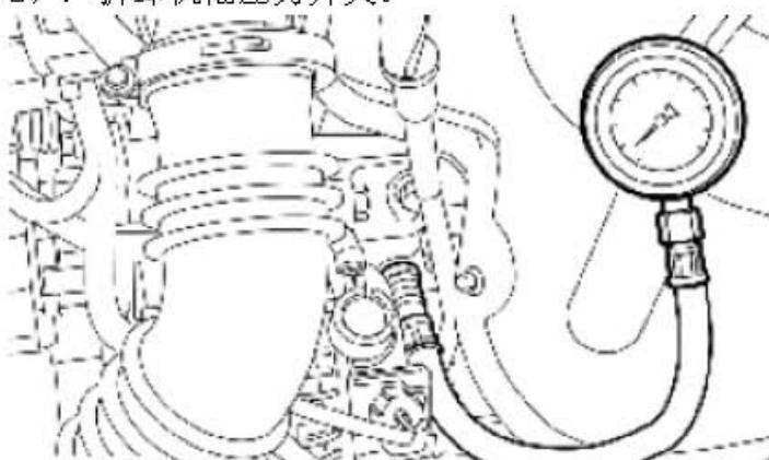
3) . 使用机油压力表接头连接机油压力表。
