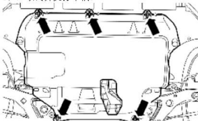
2). 拆卸发动机下护板。
