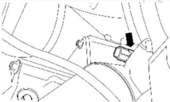
3) . 拆卸机油压力开关。
