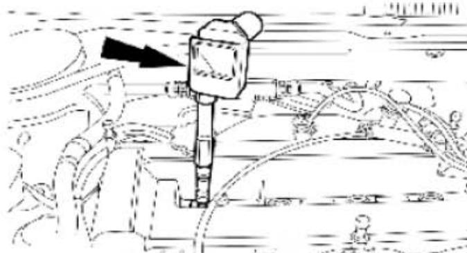
10). 依据制造商所提供的指示在每一气缸使用适当的压缩压力记录表与适当的转接气来执行测量。
