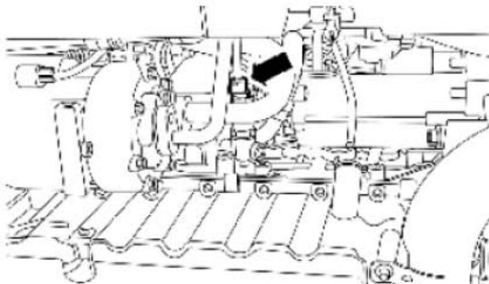
10) . 连接机油压力开关的电气接头到机油压力开关。
