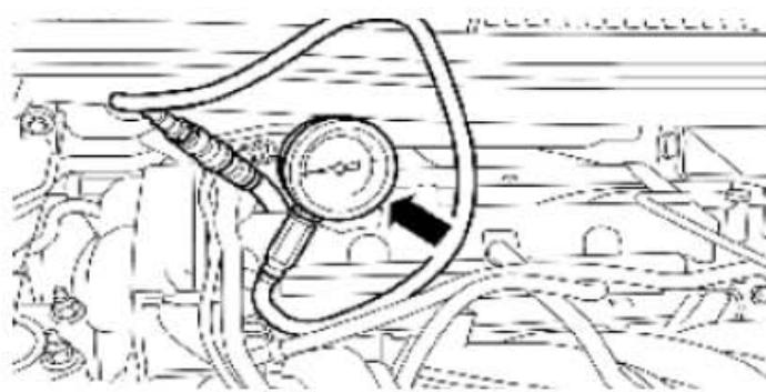
7). 依据制造商所提供的指示在每一气缸使用适当的压缩压力记录表与适当的转接气来执行测量。
