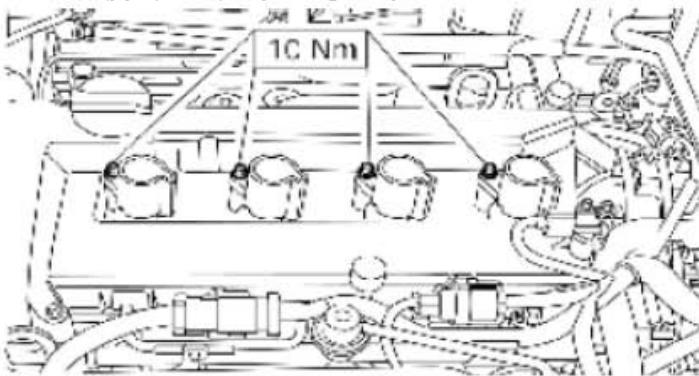
12). 安装点火线圈顶置火花塞。
