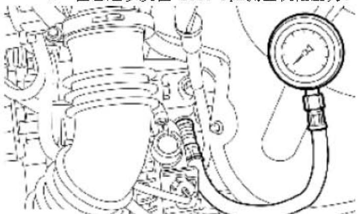
5) . 拆开机油压力表与机油压力表接头。
