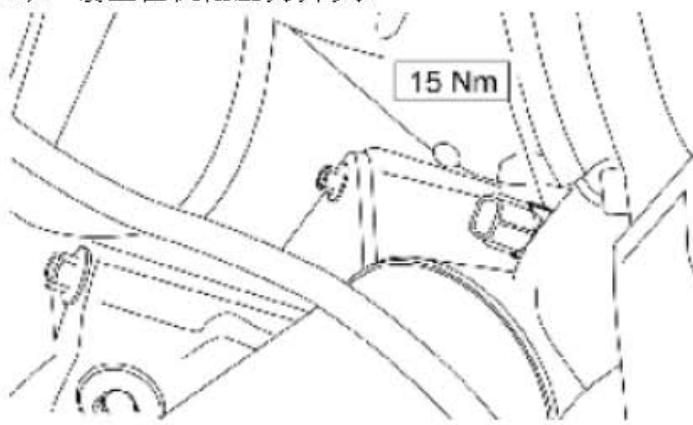
10). 安装机油压力开关。
