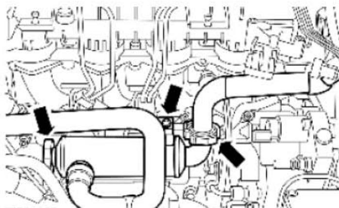
10). 拆开废气再循环 (EGR) 冷却器 (若有配备) 与另外一侧对准。
