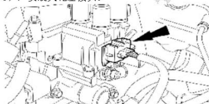
10) . 连接 EI 线圈接头到 EI 线圈。
