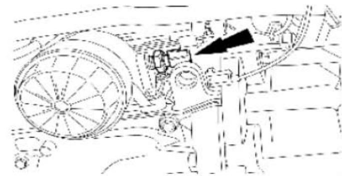
4) . 拆卸机油压34力开关。
