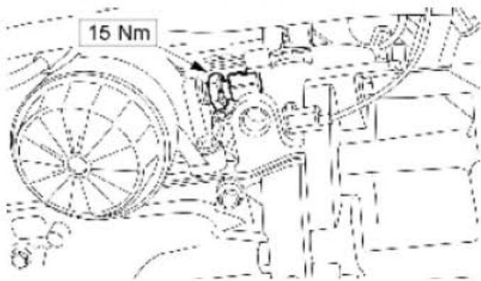
11). 安装机油压力开关。
