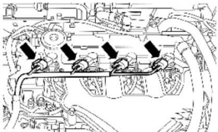
9) . 拆开燃油喷油嘴电气接头。
