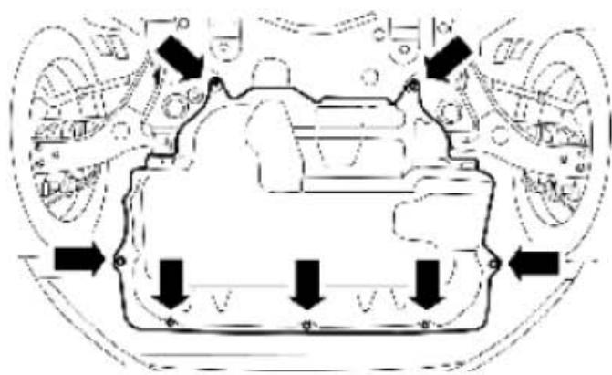
3). 拆卸发动机下护板。
