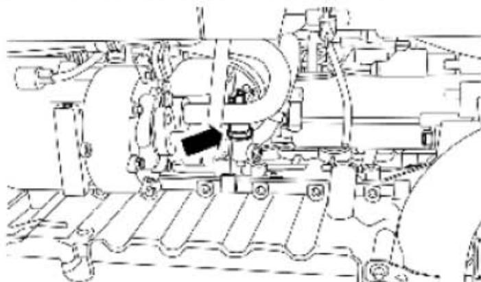
4). 拆卸机油压力开关。
