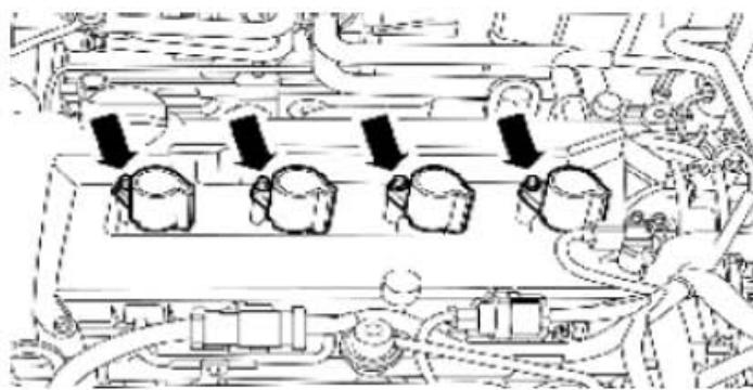
8). 拆卸点火线圈顶置火花塞。
