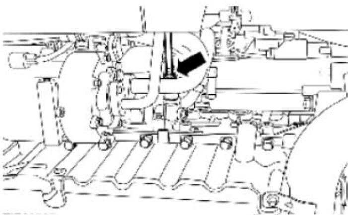
5). 使用机油压力表接头连接机油压力表。
