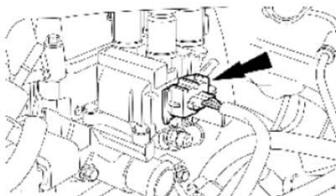
4). 从 EI 线圈上拆开电子点火(EI) 线圈接头。
