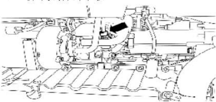
3). 从机油压力开关上拆开机油压力开关电气接头。
