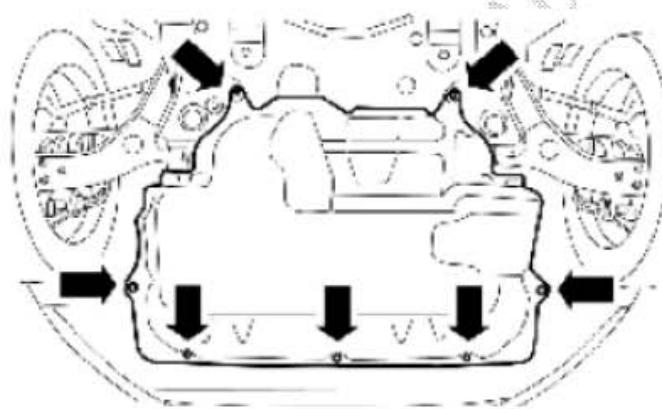
11) . 安装发动机下护板。
