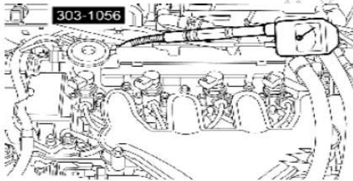
14). 安装专用工具并且使用一组适当的压缩比测试器装入预热塞缸径中。
