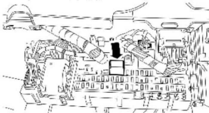
17). 安装燃油泵继电器并关闭 CJB。
