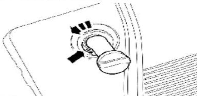
5) . 拆卸机油添加管。释放固定扣并逆时针转动机油添加管。
