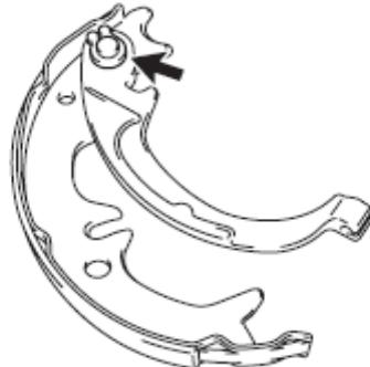
B). 用测隙规测量 2 号驻车制动蹄总成和驻车制动蹄拉杆之间的间隙。
